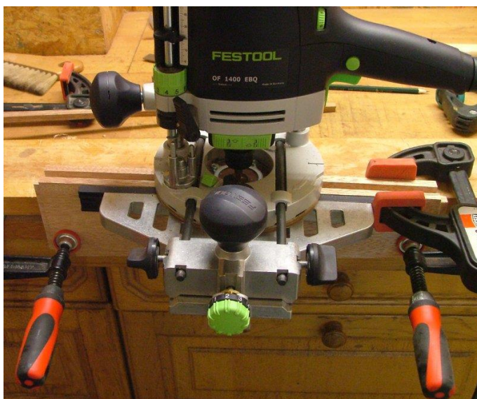
Abbildung 16: Bohren mit der Oberfräse
